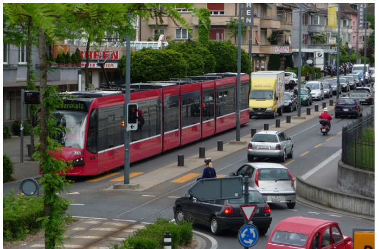
Abb. 38: Ein Tram durchfährt einen Kreisel in Wabern. Der Kreisel ist mittels Lichtsignal gesichert, so dass das Tram ungehindert passieren kann. (Bild: www.bve.be.ch )
