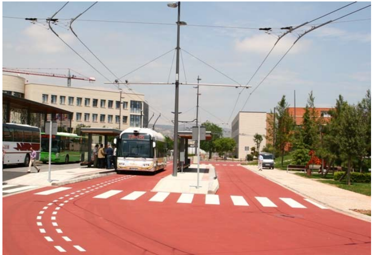
Abb. 14: Ein Trolleybus an der Endhaltestelle Universität. Zu sehen ist auch die Markierung der optischen Spurführung und eine Zweithaltestelle ohne Spurführung. (Bild: http://www.trolleymotion.ch/ )
